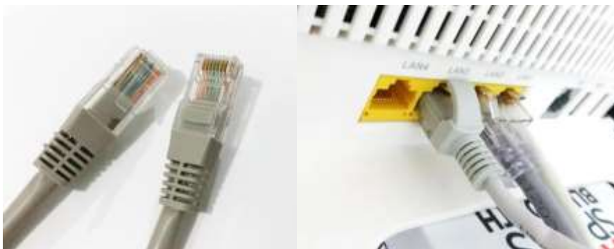
ภาพที่ 3.14 (ซ้าย) RJ-45 jack และ (ขวา) RJ-45 port บน Router
