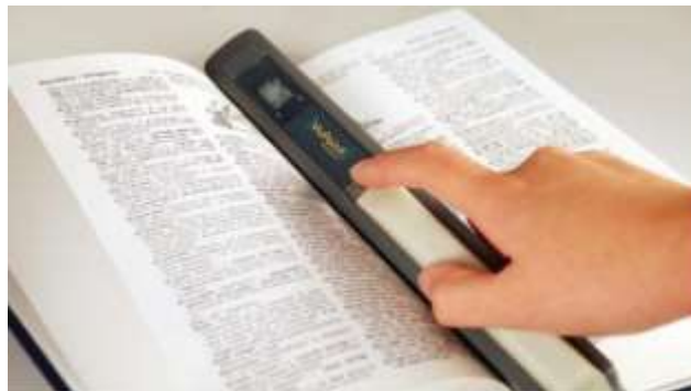
ภาพที่ 2.5 แสดงเครื่องสแกนเนอร์ที่พัฒนาให้มีความสะดวกในการใช้งานและเคลื่อนย้าย
